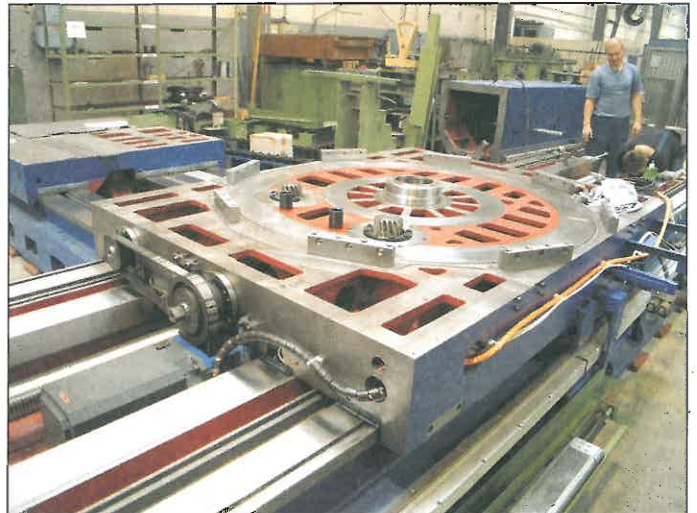
Na tomto snímku vidíte detaily z inovovaného stroje WHN(Q) 13 CNC, konkrétně lože a saně stolu.
