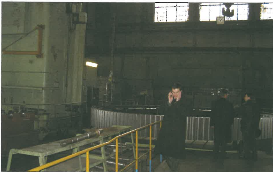
Část naší delegace u největší horizontky v NKMZ (je to speciální stroj s vřetenem 300 mm a stolem 4000 x 6000 mm).
