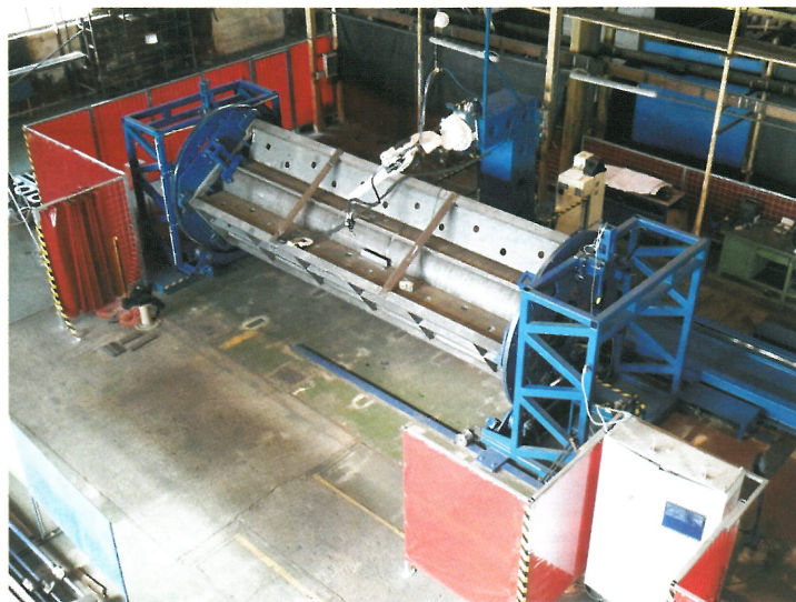
Robotizované svářecí pracoviště v hale společnosti DAM.
