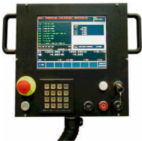
自动换刀装置控制面板 ATC AUXILIARY CONTROL PANEL
