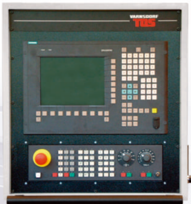
西门子Sinumerik 840 D控制面板 CONTROL PANEL OF SINUMERIK 840 D CONTROL SYSTEM
