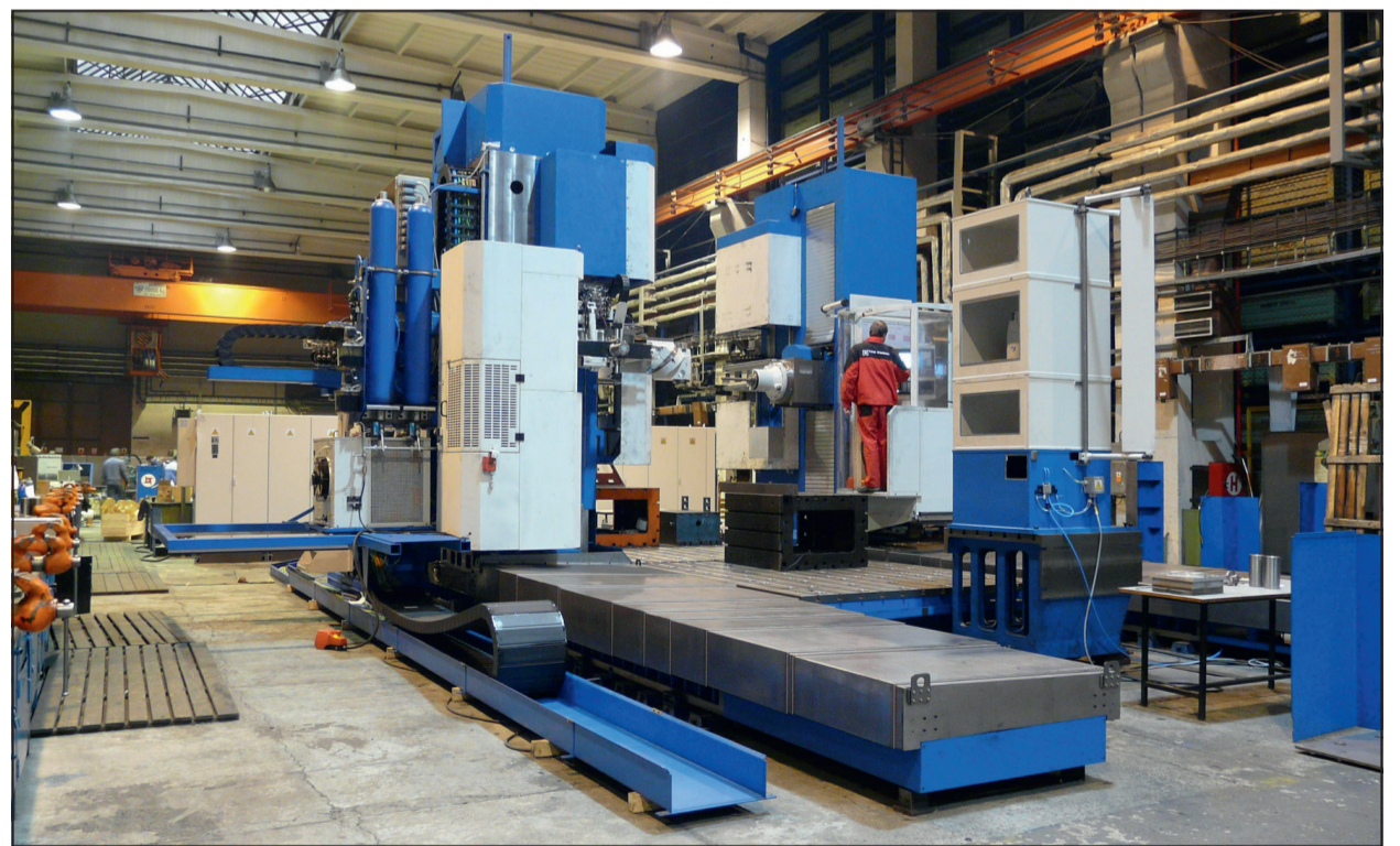
Obráběcí centrum s posuvným stojanem FUQ-VR/8 v provedení DUO (TOS KUŘIM-OS, a.s.)
