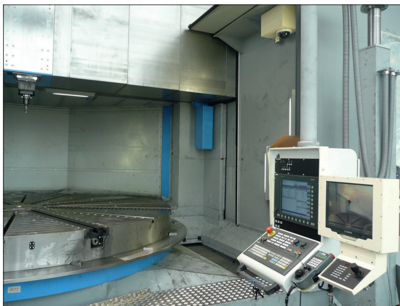
Operátor může sledovat obrábění vysokých dílců díky kameře umístěné v pracovním prostoru (TOSHULIN, a. s.)
