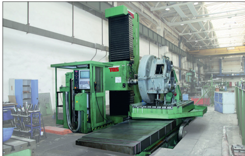
Opracování části převodovky těžebního stroje na stroji WHQ 13 CNC (TOS VARNSDORF, a. s.)
