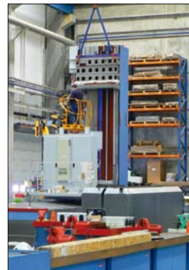
Vodorovný frézovací a vyvrtávací stroj WRD 150 Q - zrození veličana
